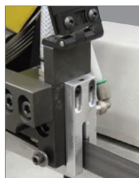
DMI Doppia morsa idraulica - tagli a 0°. Hydraulic double vice - cut at 0°. Double étau hydraulique - coupes 0°.
