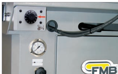
RPM1 Regolazione pressione morsa. Vice pressure adjustment. Reglage de la pression de serrage de l'etau.
