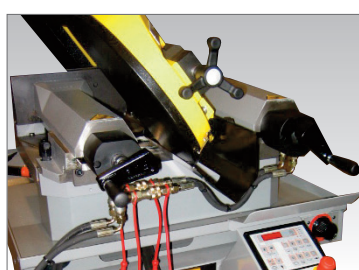
DMI Doppia morsa idraulica - tagli a 0°. Hydraulic double vice - cut at 0°. Double étau hydraulique - coupes 0°.
