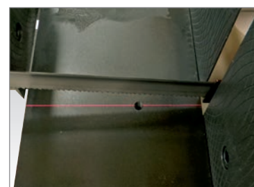
LX Illuminazione linea di taglio con laser. Laser lighting for cutting line. Projection de la ligne coupe par laser.
