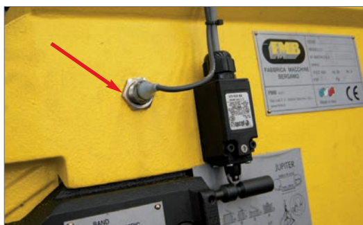
SENS Sensore rotazione nastro Blade rotation sensor Contrôle de defilement du ruban par detecteur
